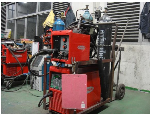
รูปที่ 3.3 เครื่องเชื่อมอาร์กลวดเชื่อมได้ฟลักซ์
