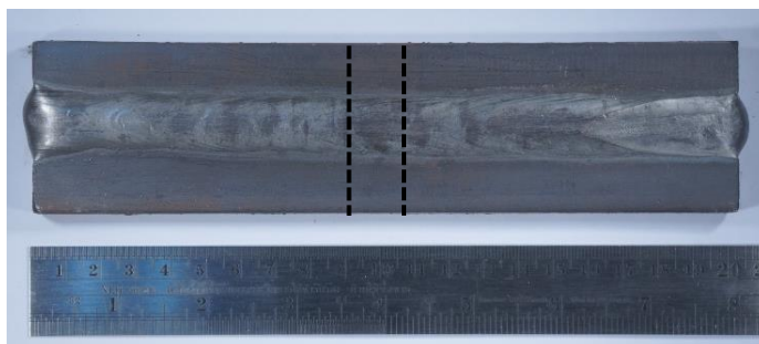
รูปที่ 3.9 ตำแหน่งการตัดชิ้นงานทดสอบเพื่อตรวจสอบโครงสร้างมหภาค/จุลภาคและความแข็ง
