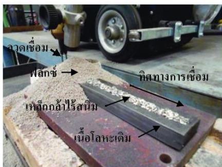
รูปที่ 2 การเชื่อมอาร์กใต้ฟลักซ์โดยใช้ลวดเชื่อมคู่ที่มีการเติม โครเมียม
