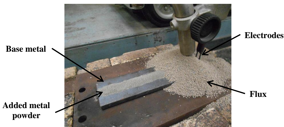
รูปที่ 3.8 การเชื่อมพอกแข็งเหล็กกล้าเกรด SS400 โดยกรรมวิธีการเชื่อมอาร์กใต้ฟลักซ์ที่มีการเติมผงโลหะ
