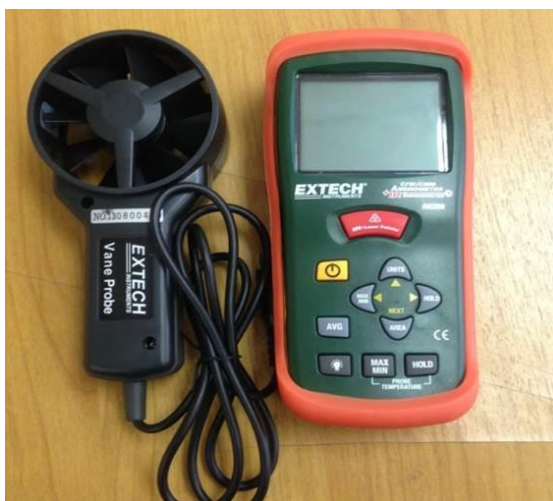
รูปที่ 3.8 เครื่อง Thermo-Anemometro PCM/MCM + Termometro infrarrojo Modelo AN 200
