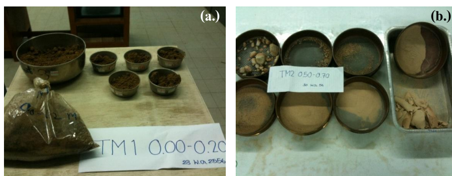
รูปที่ 3.7 ภาพแสดงตัวอย่างทดสอบคุณสมบัติทางกายภาพของลาดดินในห้องปฏิบัติการ (a.) ภาพแสดงตัวอย่างดินในการทดสอบหาความชื้นในมวลดิน (b.) ภาพแสดงตัวอย่างดินทดสอบหาขนาดคละของเม็ดดิน โดยวิธี Wet sieve
