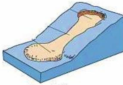
รูปที่ 2.28 ภาพแสดงรูปแบบการพิบัติแบบการไหลแบบดินไหล (Earth flow) (Highland and Bobrowsky, 2008)
