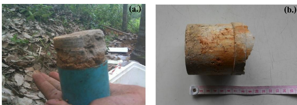
รูปที่ 3.4 ภาพแสดงตัวอย่างดินคงสภาพ (a.) ที่เก็บได้จาก KU – Miniature sampler (b.) ตัวอย่างดินคงสภาพเมื่อดันออกจากกระบอกเก็บตัวอย่าง
