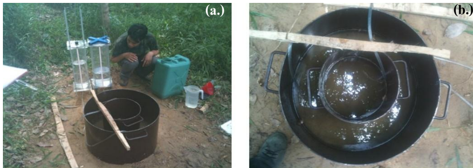
รูปที่ 3.6 ภาพแสดงการทดสอบค่าการซึมน้ำของดินด้วยวิธี Double – Ring infiltrometer test (a.) และ (b.) ณ ตำแหน่งส่วนบนของลาดดิน (TM)
