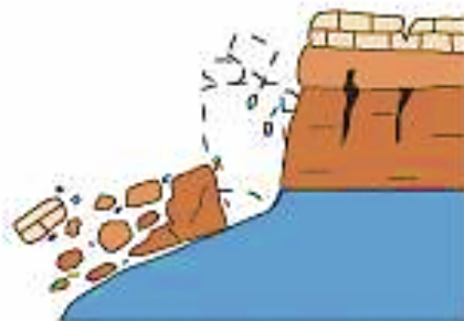
รูปที่ 2.21 ภาพแสดงรูปแบบการพิบัติแบบการล้มคว่ำ (Topples) (Highland and Bobrowsky, 2008)
