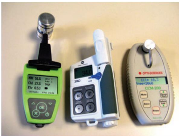
ภาพที่ 8 ตัวอย่างของคลอโรฟิลล์มิเตอร์ โดยเรียงจากซ้ายไปขวา ได้แก่: leaf-clip sensors, SPAD-502 และ CCM-200 ที่มา: Cerovic และคณะ (2012)
