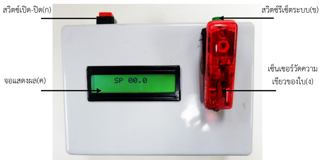
ภาพที่ 10 ส่วนประกอบของตัวเครื่องต้นแบบคลอโรฟิลล์มิเตอร์ (PSU-CM 1)
