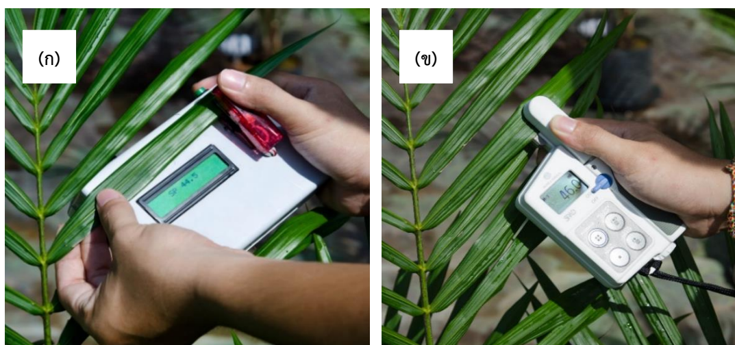
ภาพที่ 15 การใช้ PSU-CM 1(ก) และ SPAD 502(ข) วัดค่าความเขียวของใบปาล์มน้ำมัน
