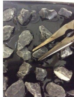
รูปที่ 5 การดึงวัสดุมวลรวมออกจากภาดในการทดสอบการหลุดออก
