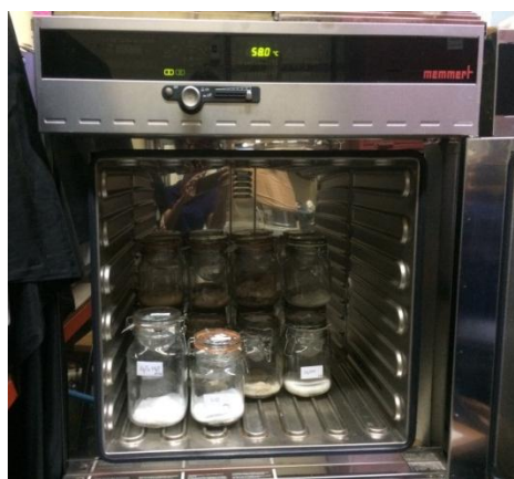
ภาพประกอบที่ 3.2 เครื่องมือหาความชื้นสมดุล
