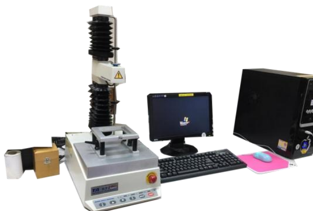
ภาพประกอบที่ 3.5 เครื่อง Texture analyzer รุ่น TA-XT plus
