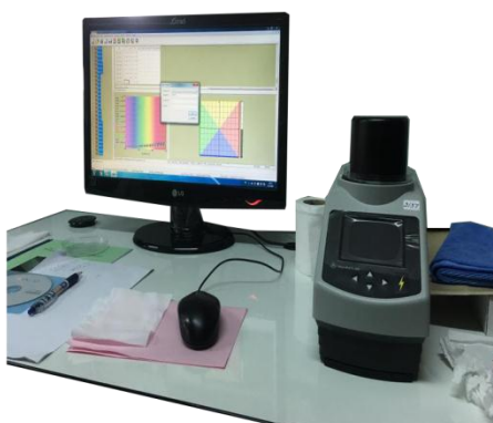
ภาพประกอบที่ 3.4 แสดงเครื่องวัดสีอาหาร Hunter Lab รุ่น Color Flex
