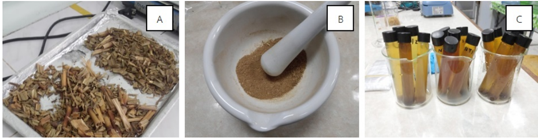
รูปที่ 3-11 (A) หน้ำนเปียร์หลังอบ (B) หน้ำนเปียร์หลังบด และ (C) ตัวอย่างที่สกัดในหลอดทดลอง
