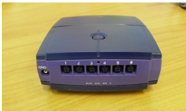
รูปที่ 3.2 เครื่องขยายและบันทึกสัญญาณไฟฟ้ากล้ามเนื้อยี่ห้อ Mobi6
