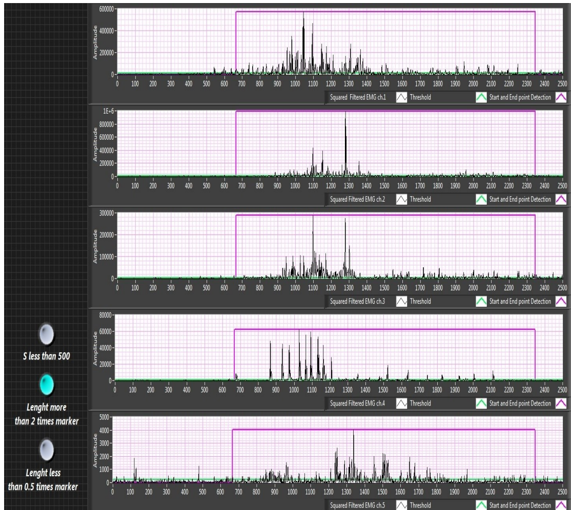
รูปที่ 3.23 แสดงผลของการใช้โปรแกรมตรวจจับจุดเริ่มต้นและจุดสิ้นสุดของสัญญาณไฟฟ้ากล้ามเนื้อ ซึ่งผลของการตรวจจับเข้าเงื่อนไขของการตรวจจับผิดพลาด
