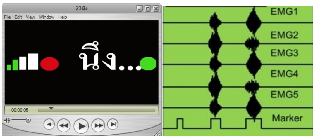
รูปที่ 3.12 ซ้าย: ตัวอย่างวิดีโอที่ใช้ขณะเก็บข้อมูลสัญญาณไฟฟ้ากล้ามเนื้อขณะออกเสียงพูด ขวา: ลักษณะการกดสวิทช์ขณะการออกเสียงพูดเพื่อเก็บข้อมูลสัญญาณไฟฟ้ากล้ามเนื้อ
