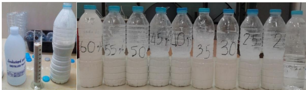
รูปที่ 4.1 การเจือจางน้ำยางชั้นด้วยน้ำกลั่นขนาด 200 มิลลิลิตร
