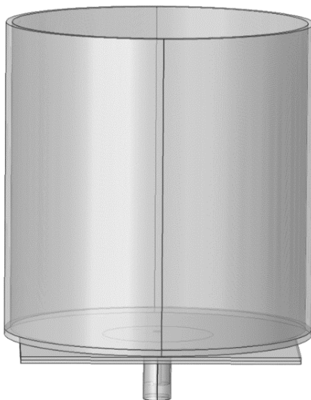
รูปที่ 3.15 โมเดลจำลองสายอากาศแพทช์แบบวงกลมวางอยู่ใต้ภาชนะแก้วด้วยโปรแกรม COMSOL Multiphysics
