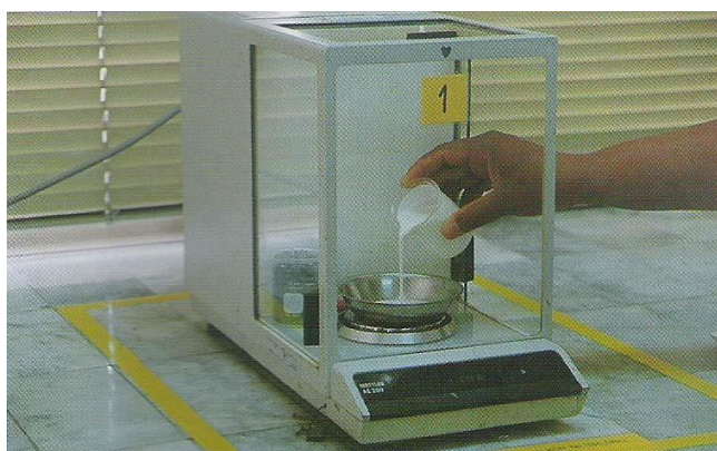
รูปที่ 2.3 การชั่งน้ำหนักตัวอย่างน้ำยางสด [4]
