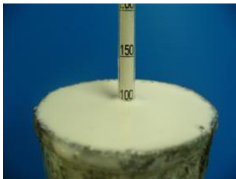
รูปที่ 2.6 การวัดค่าปริมาณเนื้อยางแห้งในน้ำยางสดด้วยเครื่องเมโทรเล็ก
