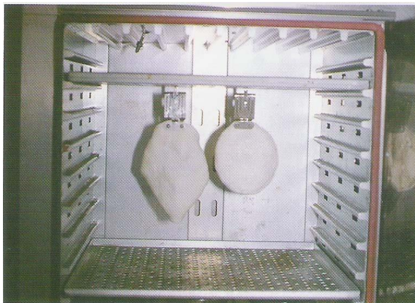
รูปที่ 2.4 การอบแผ่นยางอุณหภูมิ 70 องศาเซลเซียส [4]
