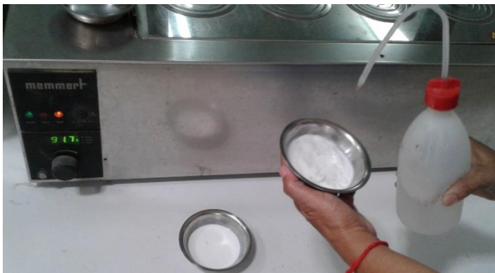
รูปที่ 4.4 การจับตัวของน้ำยางด้วยกรดอะซิติกความเข้มข้น 2 เปอร์เซ็นต์
