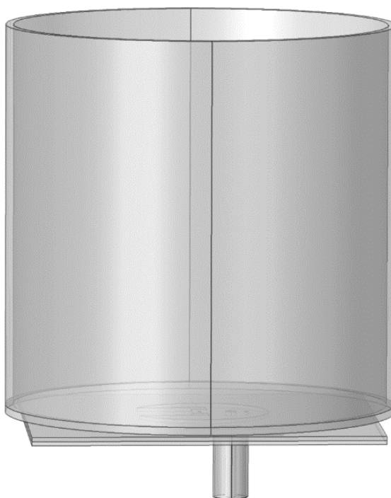
รูปที่ 3.22 การจำลองสายอากาศ MCP เมื่อวางอยู่ใต้ภาชนะแก้วเปล่าด้วยโปรแกรม COMSOL multiphysics
