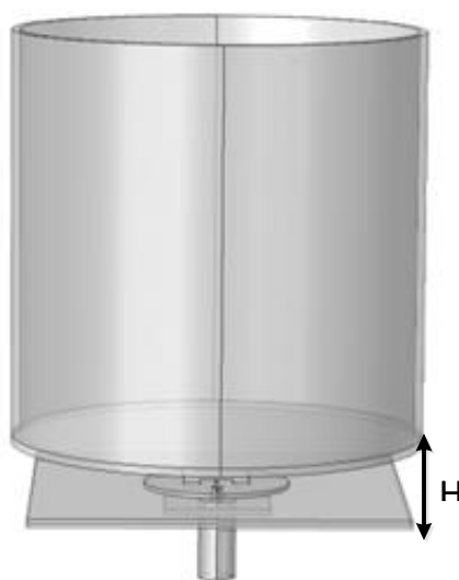
รูปที่ 4.18 การจำลองโมเดลการวัดค่าสัมประสิทธิ์การสะท้อนของน้ำข้างแต่ละความเข้มข้นด้วยโปรแกรม COMSOL multiphysics
