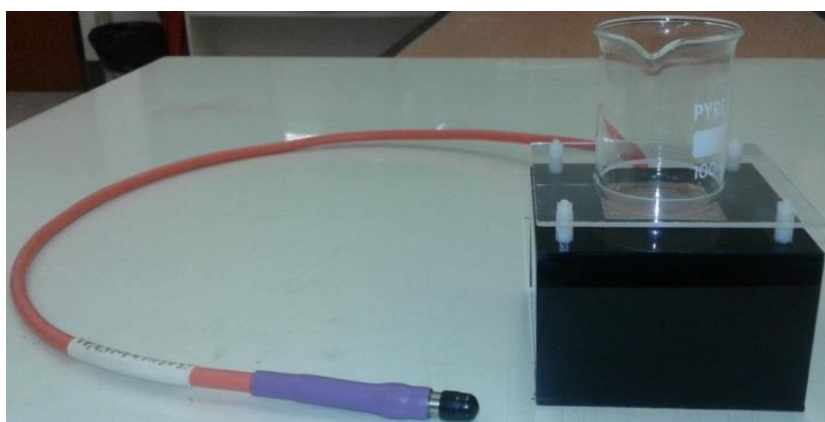
รูปที่ 3.45 โมเดลสายอากาศ MCP เพื่อวัดค่าสัมประสิทธิ์การสะท้อนของน้ำยางขึ้น
