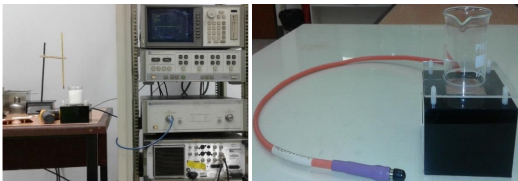
รูปที่ 4.36 การวัดค่าสัมประสิทธิ์การสะท้อนด้วยชุดทดสอบต้นแบบสายอากาศ MCP
