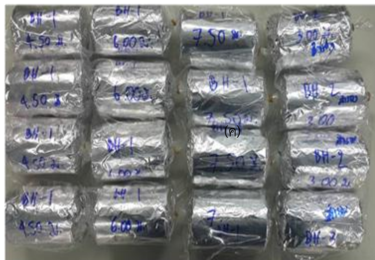
รูปที่ 3.2 (ก) แสดงการเก็บตัวอย่างดินเหนียวปากพั้ง (ข) แสดงการเก็บดินในกระบอกผนังบาง (ค) แสดงการเก็บรักษาก่อนตัวอย่างดินเพื่อรอทำการทดสอบ
