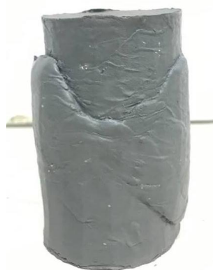
รูปที่ 4.27 รูปตัวอย่างดิน NC clay หลังการเฉือนที่อัตราความเครียดต่ำ
