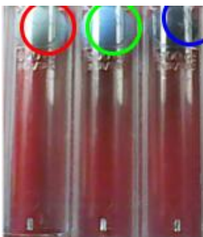
ภาพประกอบ 5-5 ผลกระทบจากแสงสะท้อนที่เกิดขึ้นบนกระบอกพลาสติก
