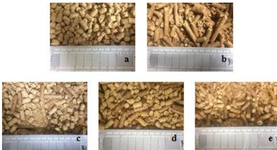
รูปที่ 4.6 แสดงลักษณะเชื้อเพลิงผสมระหว่างแกลบอัดเม็ดและขี้เลื่อยอัดเม็ดที่อัตราส่วนโดยน้ำหนัก (a) 100:0, (b) 0:100, (c) 75:25, (d) 50:50, (e) 25:75
