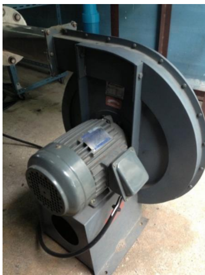
รูปที่ 3.5 แสดงลักษณะพัดลมเป่าอากาศ (Blower)
