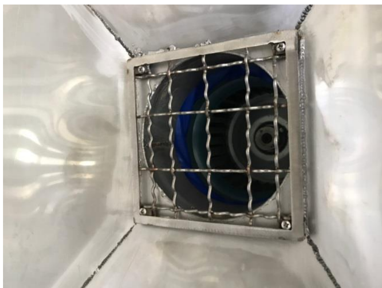
รูปที่ 4.30 ตะแกรงกันเศษชิ้นกล้วย ตู้อบลมร้อน
