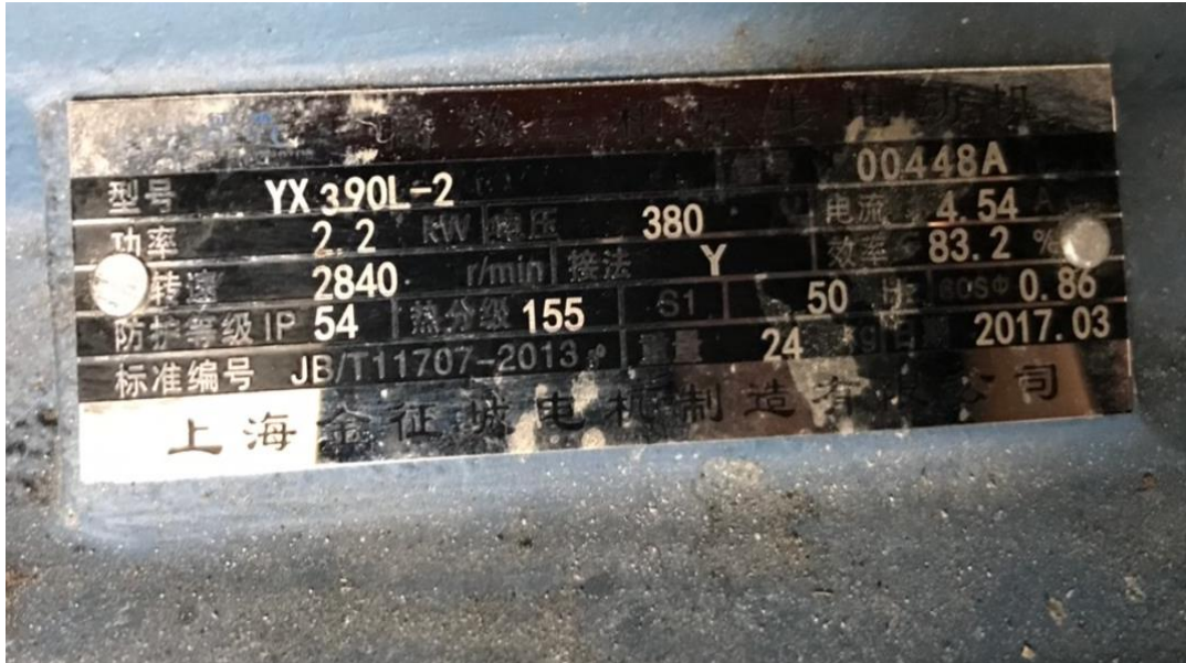
รูปที่ 4.36 มอเตอร์ที่ติดตั้งมากับเครื่องบด
