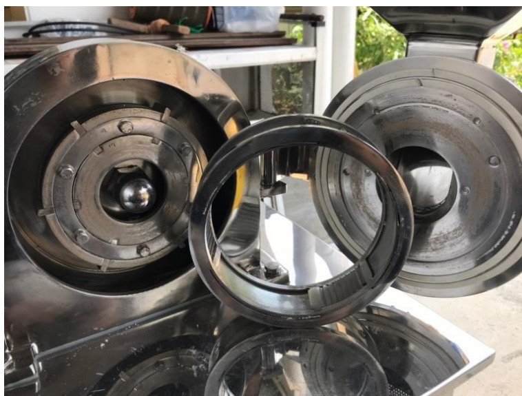
รูปที่ 4.40 ภายในห้องบด เครื่องบด
