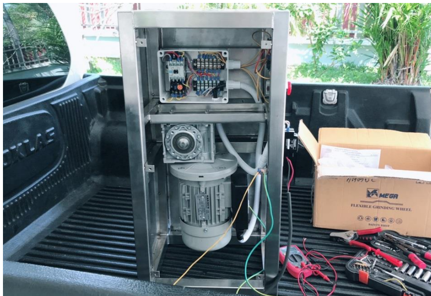
รูปที่ 4.6 อุปกรณ์สวิตช์ตัดต่อวงจรไฟฟ้า (Magnetic Contactor)
