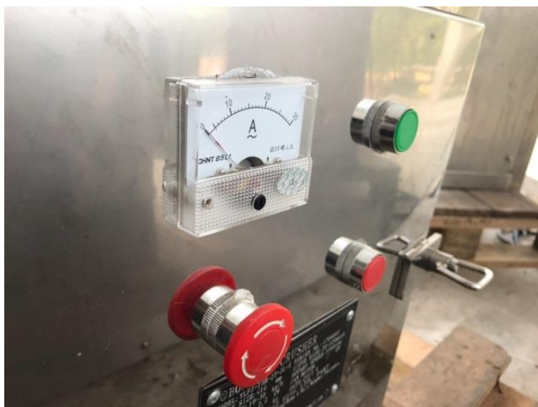
รูปที่ 4.42 แผงควบคุมการทำงานของเครื่องบด
