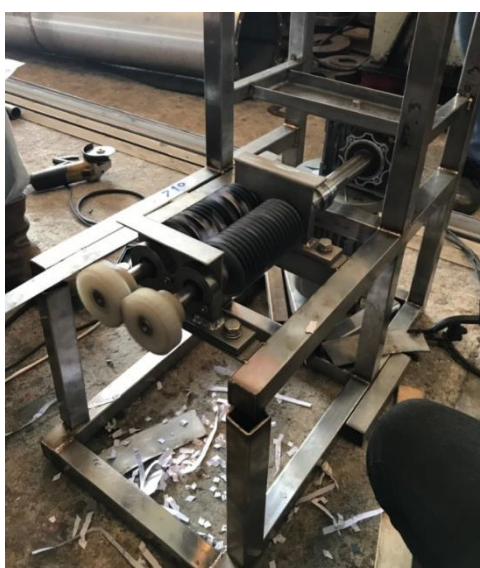
รูปที่ 4.3 ประกอบชุดใบมีดและมอเตอร์เกียร์เข้ากับโครงสร้าง
