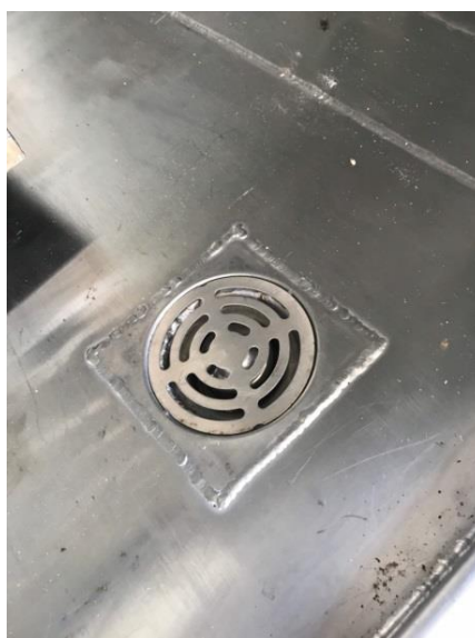
รูปที่ 4.33 ช่องระบายน้ำด้านล่างตู้อบลมร้อน
