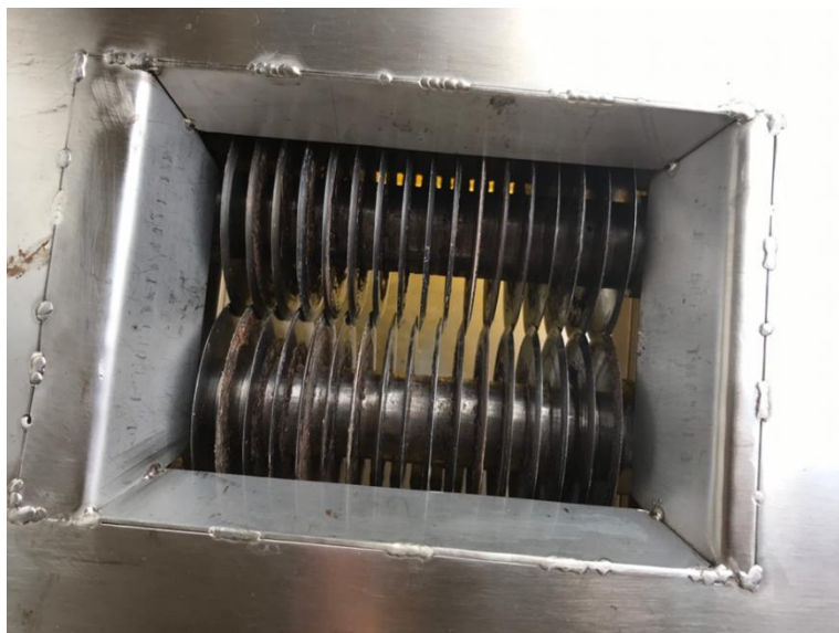
รูปที่ 4.11 ฝาครอบชั้นล่างเครื่องหั่นกล้วย
