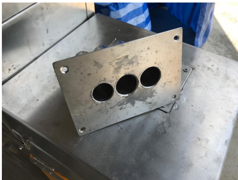
รูปที่ 4.9 ช่องใส่กล้วยเครื่องหั่นกล้วย
