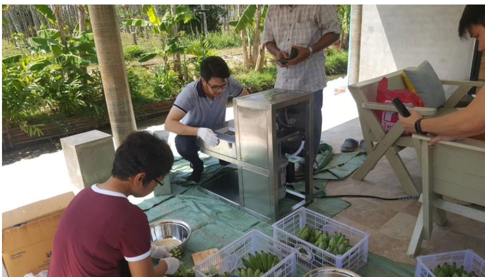
รูปที่ 4.45 ทดสอบการใช้งานเครื่องหันกล้วย
