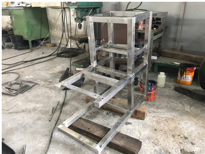
รูปที่ 4.1 โครงสร้างเครื่องหั่น
