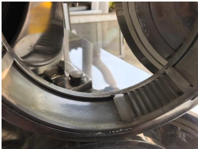
รูป 4.41 ชุดใบมีดติดตั้ง เครื่องบด
