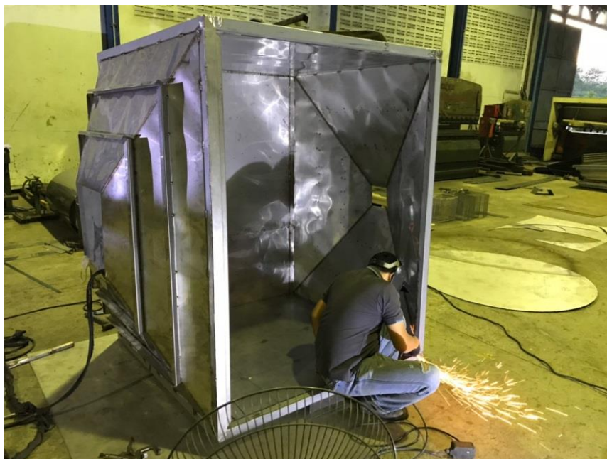
รูปที่ 4.13 โครงสร้างและผนังด้านในตู้อบ
