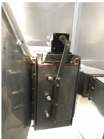
รูปที่ 4.29 ใบพัดปรับทิศทางลม ตู้อบลมร้อน
