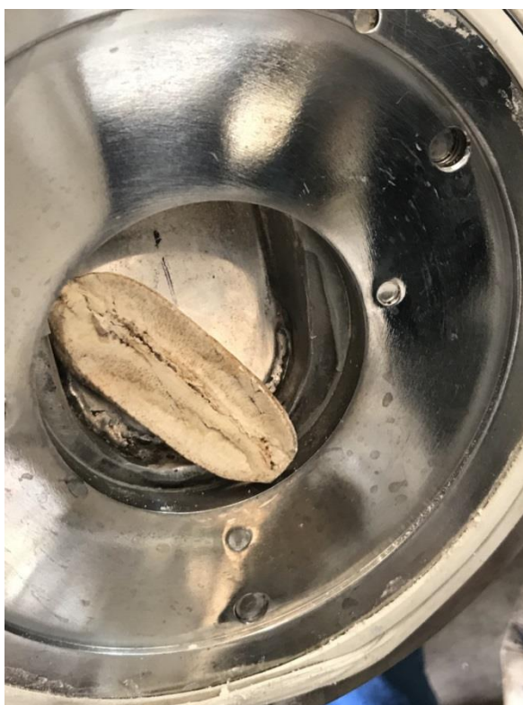
รูปที่ 4.54 ชิ้นกล้วยติดช่องป้อนเครื่องบด
