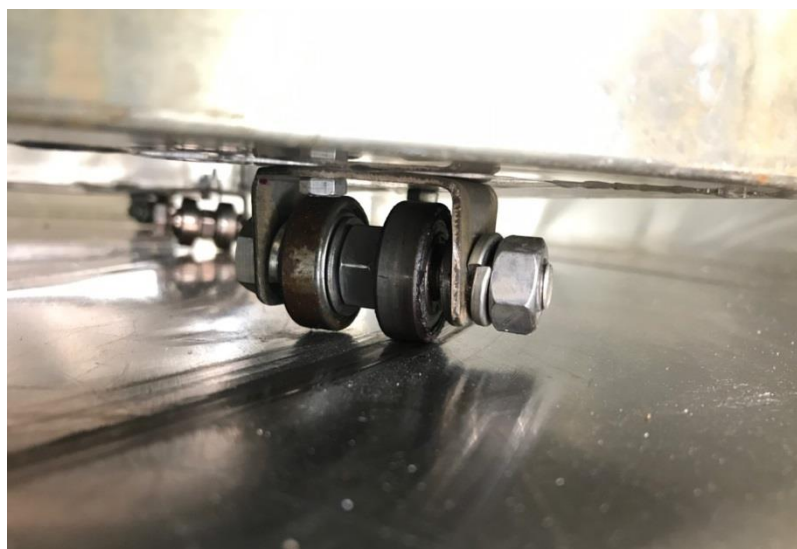
รูปที่ 4.48 ล้อของชั้นวางถาด ชุดล้อลูกปืนคู่
