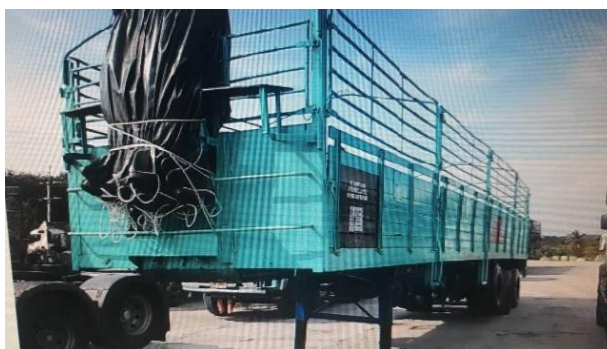
ภาพที่ 4.4 ลักษณะรถเทรลเลอร์พร้อมหาง 12 เมตรและที่ปิดด้านข้าง
