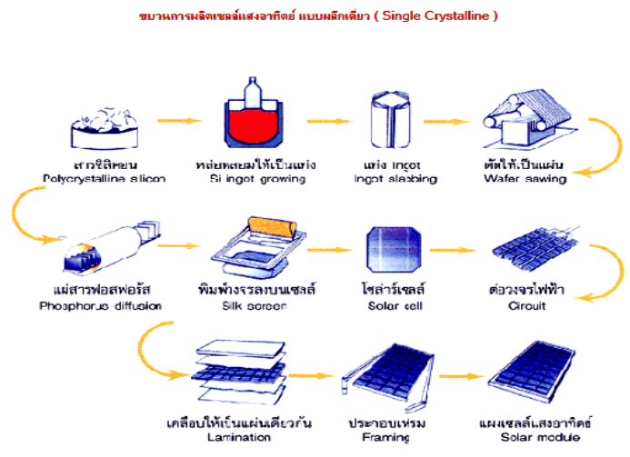
รูปที่ 2.17 กระบวนการผลิตแผงเซลล์แสงอาทิตย์
