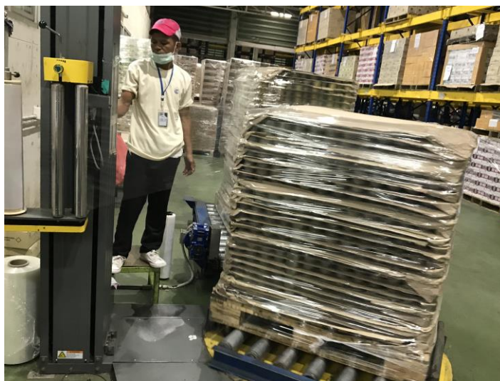
รูปที่ 4.3 การห่อผลิตภัณฑ์ด้วยเครื่องพันฟิล์มยืด (wrapping machine)
