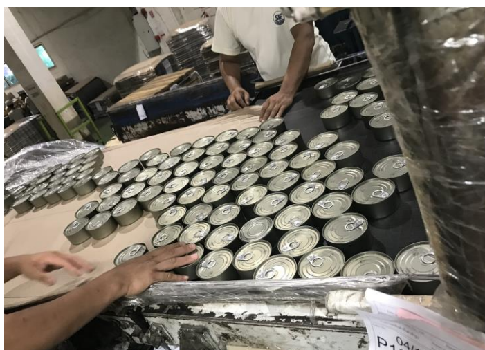
ข. การกวาดกระป๋องผลิตภัณฑ์ลงบนจานหมุนของเครื่องปิดฉลาก
