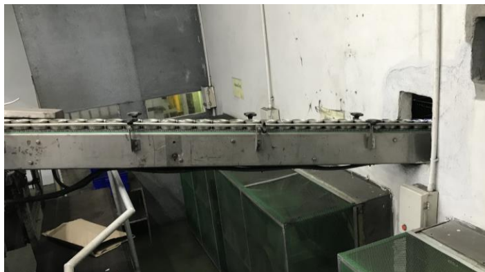
ก. การรับผลิตภัณฑ์ด้วยสายพานลำเลียงจากแผนกผลิต
