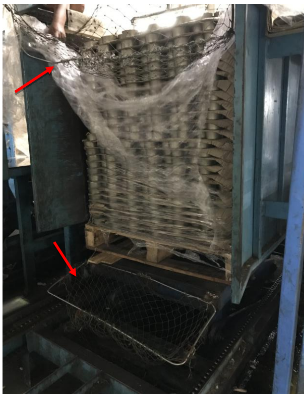
รูปที่ 4.14 การกันตาข่ายด้านข้างหัวรางเพื่อป้องกันไม่ให้กระป๋องหล่นตกพื้น
