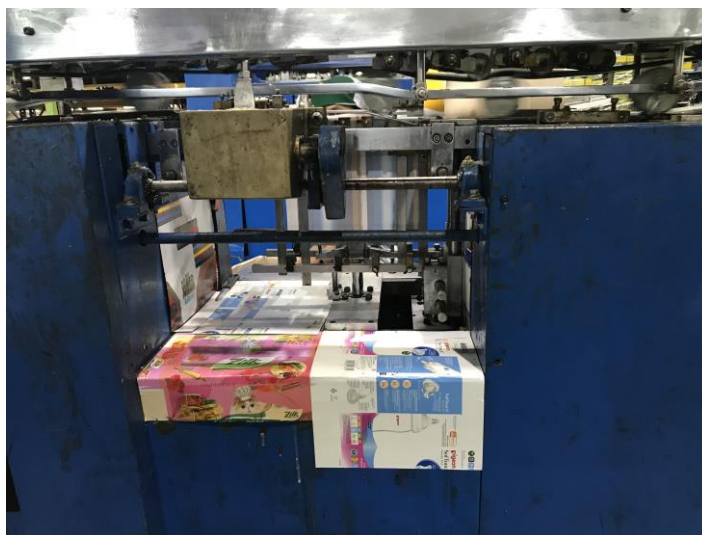
รูปที่ 4.6 การป้อนฉลากเพื่อรอกะป๋องผลิตภัณฑ์ไหลผ่านมาติดฉลาก
