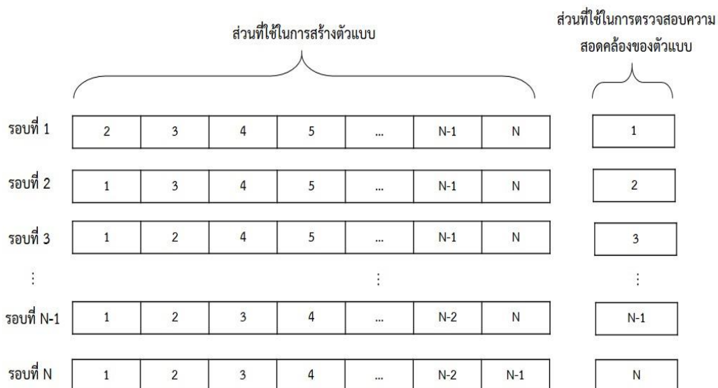
รูปที่ 3.16 วิธี leave-one-out cross-validation test
