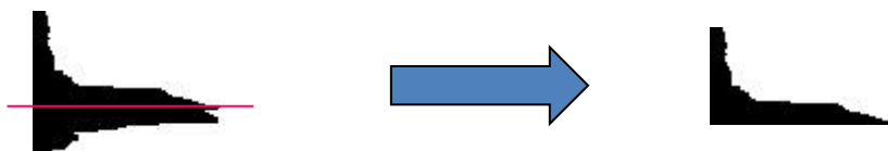
ภาพประกอบที่ 3-50 การวิเคราะห์หาส่วนบนของ Bounding Box of Object โดยใช้ Horizontal Projection
