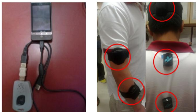
ภาพประกอบที่ 1-1 การติดเซ็นเซอร์และอุปกรณ์กับบุคคลที่ต้องการรู้จำท่าทาง [5]
