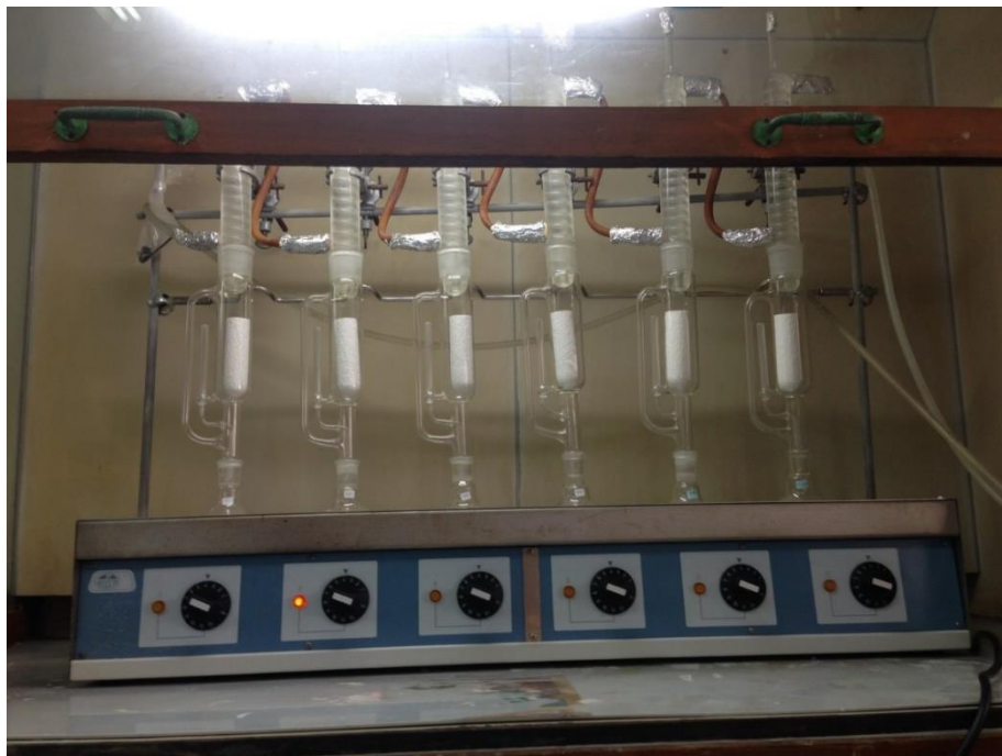
ภาพที่ 3.4 การสกัดตะกอนดินด้วย วิธีชอกเลต (soxhlet extraction)
