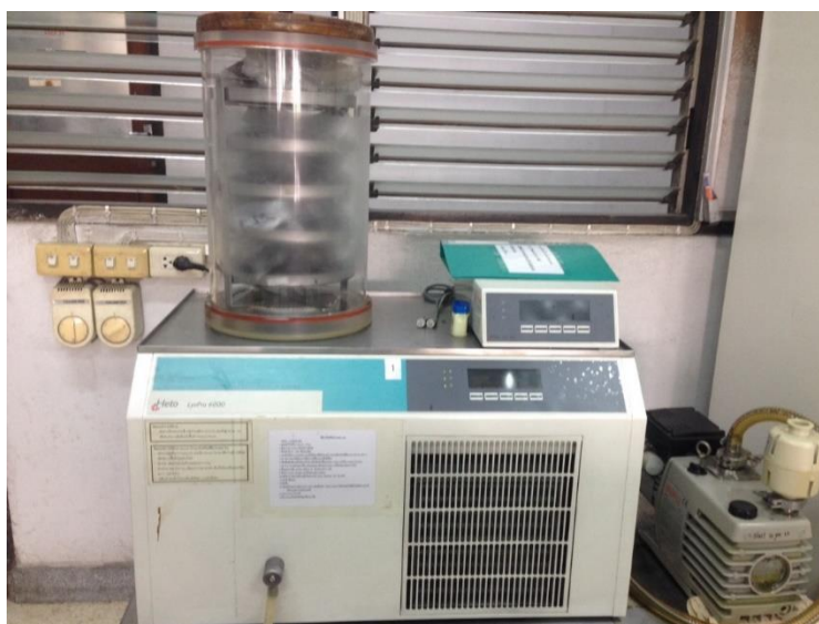
ภาพที่ 3.3 การทำตัวอย่างตะกอนดินให้แห้งด้วยวิธี freeze dry
