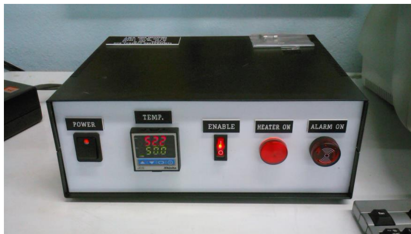
รูปที่ 4.2 ระบบควบคุมอุณหภูมิ
