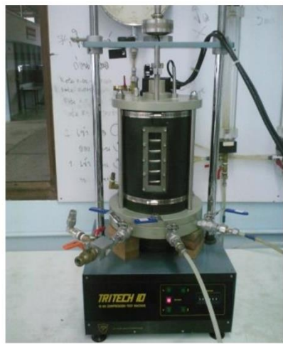
รูปที่ 8 เครื่องมือทดสอบแรงอัดสามแกนที่สามารถควบคุมอุณหภูมิได้ [1]
