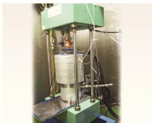
รูปที่ 5 เครื่องทดสอบสามแกนสำหรับอุณหภูมิต่ำของบริษัท มารูอิ จำกัด ประเทศญี่ปุ่น
