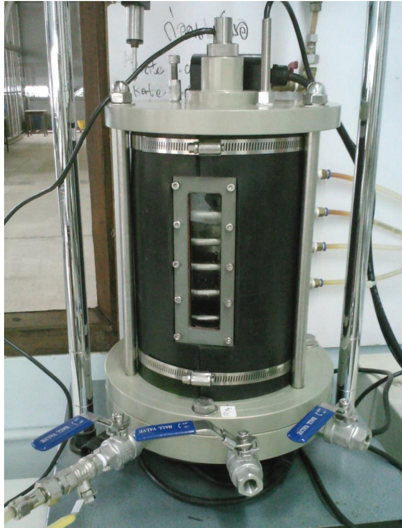
รูปที่ 4.1 เครื่องมือทดสอบแรงอัดสามแกนที่สามารถควบคุมอุณหภูมิ
