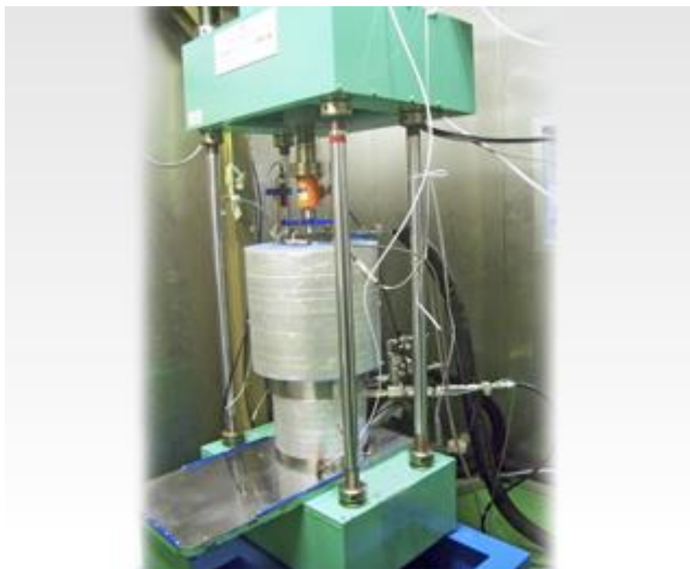
รูปที่ 2.18 เครื่องทดสอบสามแกนสำหรับอุณหภูมิต่ำของบริษัท มารูอิ จำกัด ประเทศญี่ปุ่น
