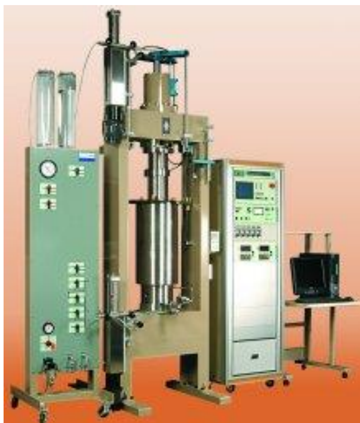
รูปที่ 2.19 เครื่องทดสอบสามแกนอุณหภูมิสูง-ต่ำและความดันสูง ของบริษัท ไชเกน จำกัด ประเทศญี่ปุ่น
