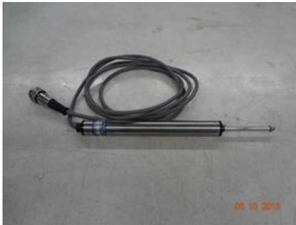
รูปที่ 4.4 ตัวแปลงสัญญาณสำหรับวัดการเคลื่อนที่
