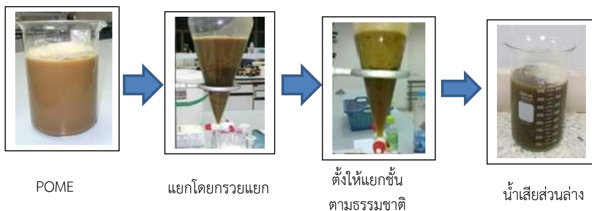
ภาพที่ 3-4 แสดงการแยกชั้นไขมันในขั้นตอนการเตรียมน้ำเสียตั้งต้น
