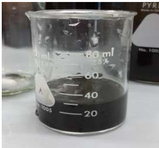
ภาพที่ 3-2 ตะกอนจุลินทรีย์ที่ใช้เป็นหัวเชื้อในกระบวนการหมัก
