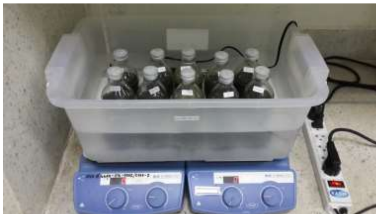
ภาพที่ 3-6 การหมักด้วยปฏิกิริยาแบบกะ (Batch)
