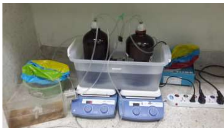
ภาพที่ 3-8 การทดลองระบบถังปฏิกรณ์ไร้อากาศแบบCSTR
