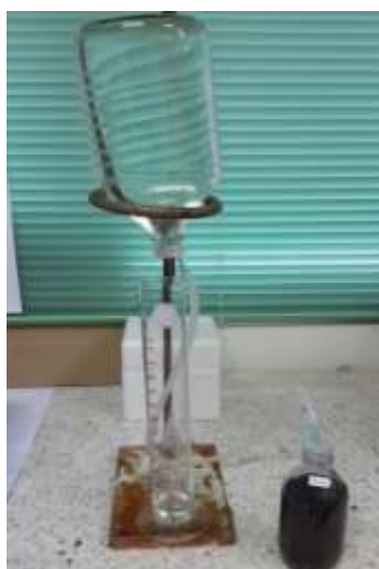
ภาพที่ 3-7 การวัดปริมาณแก๊สชีวภาพด้วยวิธีการแทนที่น้ำ
