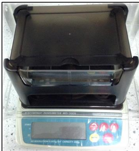
ภาพที่ 3.4 เครื่องหาความหนาแน่นระบบไฟฟ้า (Electronic density meter)
