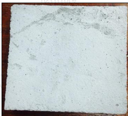
ภาพที่ 3.11 คอนกรีตบล็อกแทรกแผ่นฉนวนกันความร้อน
