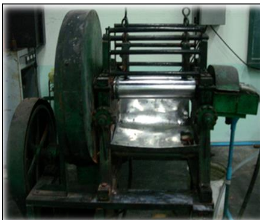
ภาพที่ 3.1 เครื่องบดผสมยางแบบสองลูกกลิ้ง (Two Roll Mill)
