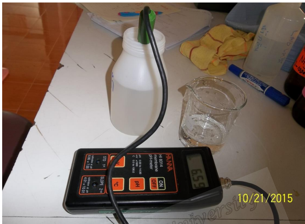
รูปผนวกที่ 15 การวัดค่าความเป็นกรดต่างของน้ำโดยใช้ pH meter
