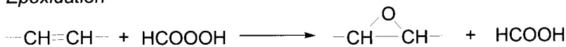
รูปที่ 2 การเกิดปฏิกิริยา Epoxidation ของน้ำมันเมล็ดยางพารา (Okieimen, et al. , 2005)
