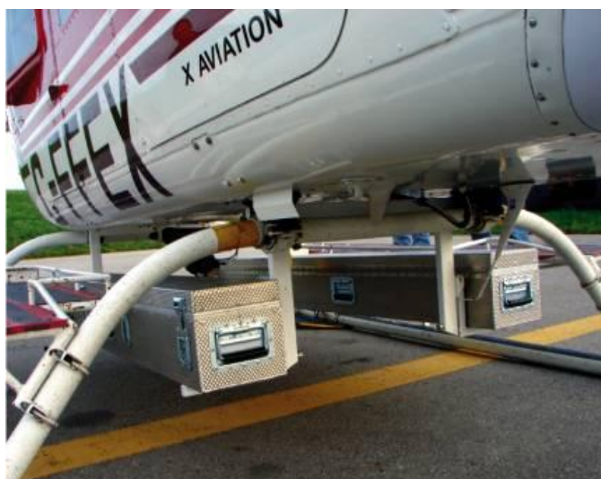
รูปที่ 2.2 หัววัดของสเปกโตรมิเตอร์รังสีแกมมาทางอากาศ (www.picoenvirotec.com, 2013)
