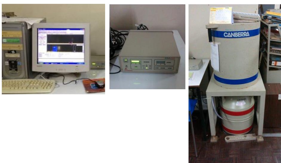
รูปที่ 3.2 แกมมาสเปกโตรมิเตอร์ (Gamma Ray Spectrometer)
