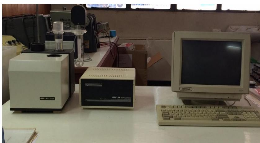
รูปที่ 3.3 เครื่องวัดสภาพปรับไว้ได้ทางแม่เหล็ก ยี่ห้อ AGICO รุ่น KLY-3S Kappabridge
