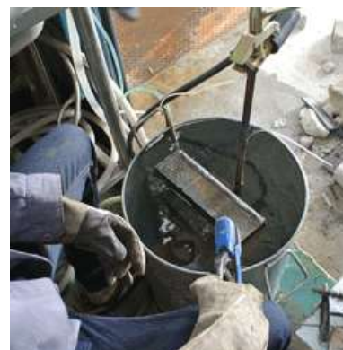
(ข) เชื่อมโดยควบคุมอุณหภูมิชิ้นงานด้วยน้ำ
