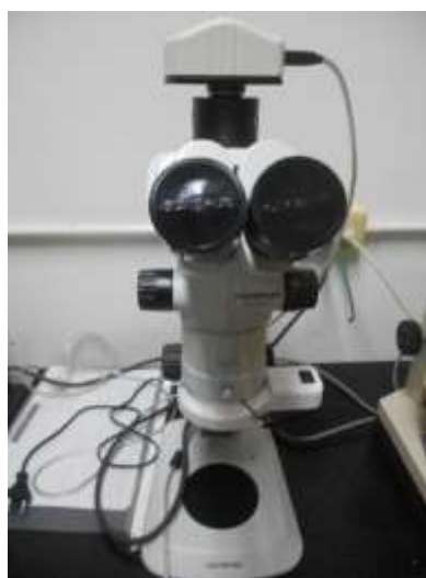
รูปที่ 3-3 กล้องจุลทรรศน์แบบใช้แสง (กำลังขยาย 4-28 เท่า)
