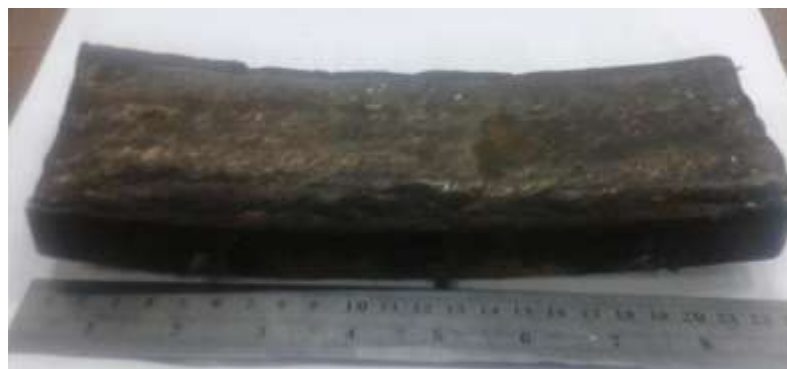
รูปที่ 3-12 ชิ้นงานทดสอบหลังเชื่อมพอกผิวแข็งในอากาศ
