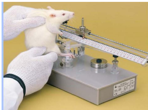
รูปที่ 2-4 การประเมินความไวในการตอบสนองต่อแรงกดด้วยเครื่อง analgesy-meter
