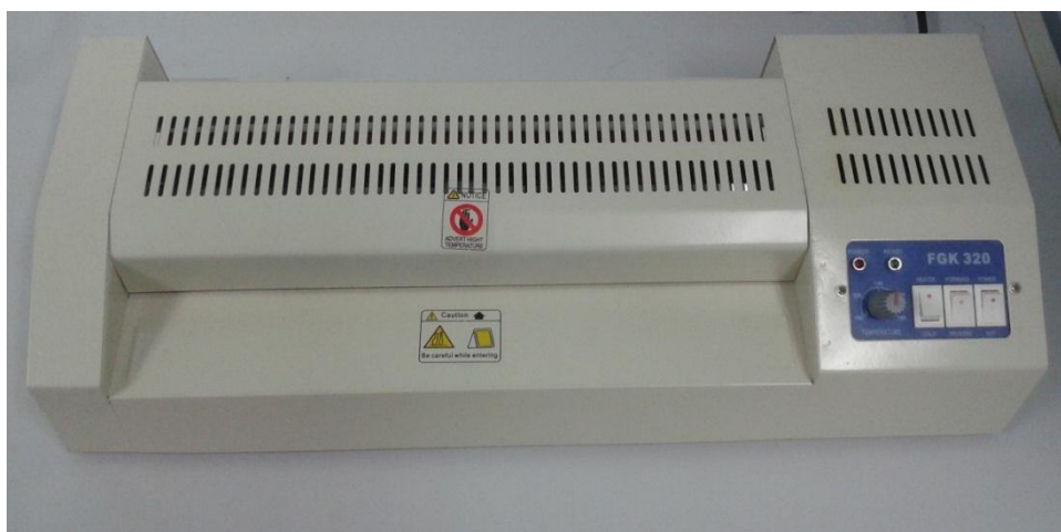
ภาพประกอบที่ 3-10 เครื่องเคลือบบัตร FGK-320 สำหรับการประกอบชิ้นงานด้วยการรีดความร้อน
