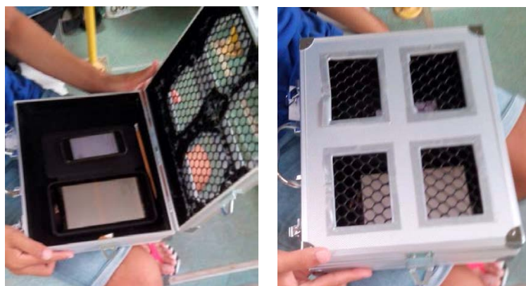
รูปที่ 3-19 สมาร์ทโฟนและกล่องบรรจุสำหรับบันทึกข้อมูลตำแหน่งรถบัส ม.อ.
