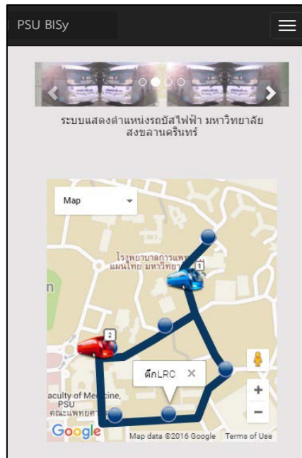
รูปที่ 4-6 หน้าจอแสดงตำแหน่งรถบัส ม.อ. บนสมาร์ตโฟน
