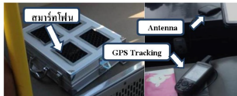
รูปที่ 9 การติดตั้งกล่องบรรจุสมาร์ตโฟนและ GPS Tracking
