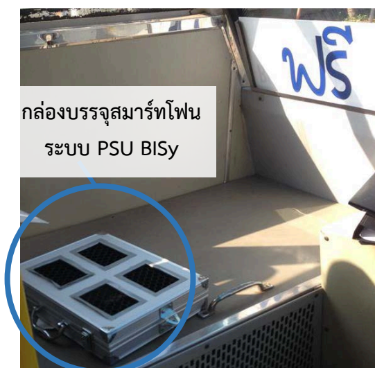
รูปที่ 3-20 การติดตั้งกล่องบรรจุสมาร์ทโฟนเพื่อบันทึกตำแหน่งรถบัส ม.อ. ขณะให้บริการ
