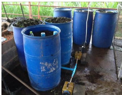
ภาพที่ 8 ชุดการทดลองหมักปุ๋ยแบบเติมอากาศและไม่เติมอากาศทั้ง 6 ชุดการทดลอง
