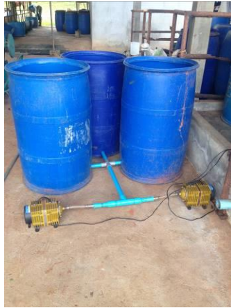
ภาพที่ 5 ถังหมักปุ๋ยแบบเติมอากาศที่ใช้ในการทดลอง
