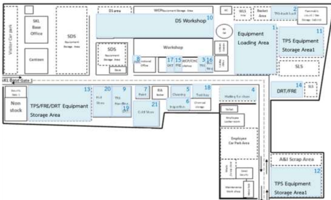
รูปที่ 4.4 แผนผังสถานีงานที่เกี่ยวข้องในการศึกษาจำนวน 21 แห่ง
