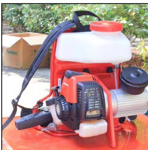
ภาพที่ 1 เครื่องพ่นฝอยละเอียดในงานวิจัย
