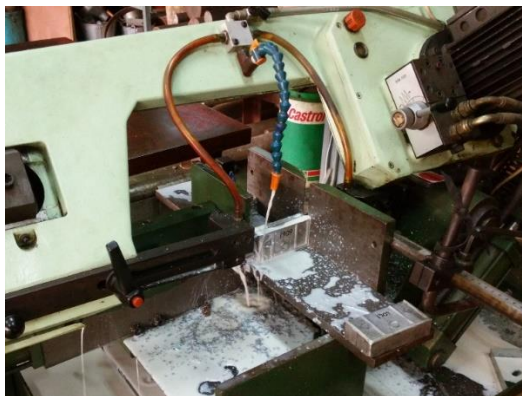
รูปที่ 3.16 การตัดชิ้นงานทดสอบด้วยเครื่องเลื่อยสายพาน
