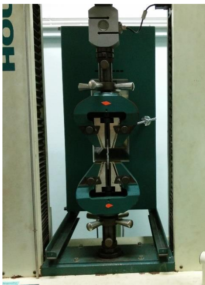
รูปที่ 3.26 ชิ้นงานขณะทดสอบความแข็งแรงดึง
