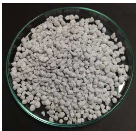
รูปที่ 2.3 เม็ดวัสดุพูนจากเถ้าแกลบขนาด 0.5 เซนติเมตร
