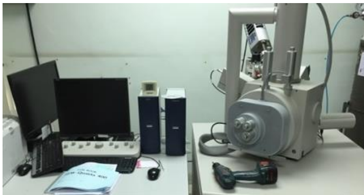
รูปที่ 3.19 เครื่องจุลทรรศน์อิเล็กตรอนแบบส่องกราด
