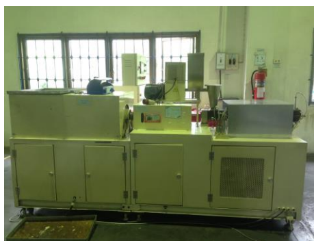
รูปที่ 3.21 เครื่องอัดรีดชนิดสกรูคู่ (Twin-screw extruder)
