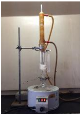
รูปที่ 3.9 ชุดสกัดตัวทำละลายโดยวิธี Soxhlet extraction
