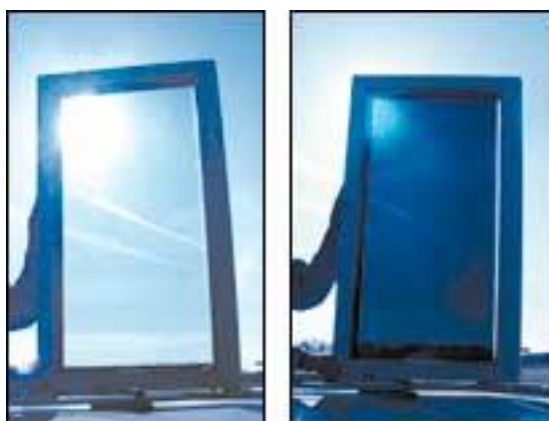
รูปที่ 1.1 ปรากฏการณ์อิเล็กโทรโครมิกของกระจก ซึ่งเปลี่ยนจากโปร่งแสงเป็นทึบแสง [52]
