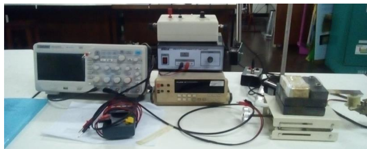
รูปที่ 4 ชุดทดสอบการสันความถี่ต่างๆของวัสดุไพเอโซอิเล็กทริก
