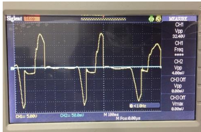
รูปที่ 8 สัญญาณเอาร์ทพุทที่ได้เมื่อมือกดเพาเวอร์แบงค์เป็นจังหวะ
