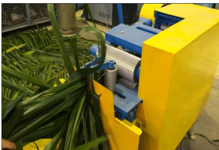
ภาพที่ 6. ทางปาล์มน้ำมันเข้าเครื่องแยกใบปาล์มผ่านชุดใบมีดคู่
