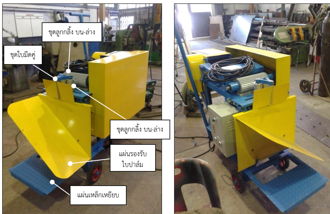
ภาพที่ 1. เครื่องแยกใบปาล์มออกจากทางปาล์มน้ำมัน
