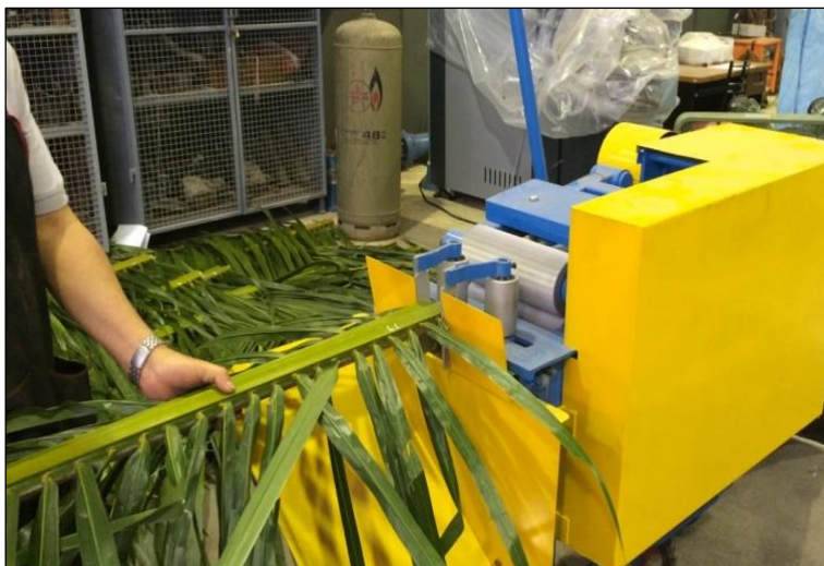
ภาพที่ 5. นำทางปาล์มน้ำมันเข้าเครื่องแยกใบปาล์มที่บริเวณด้านหน้าของชุดใบมีด
