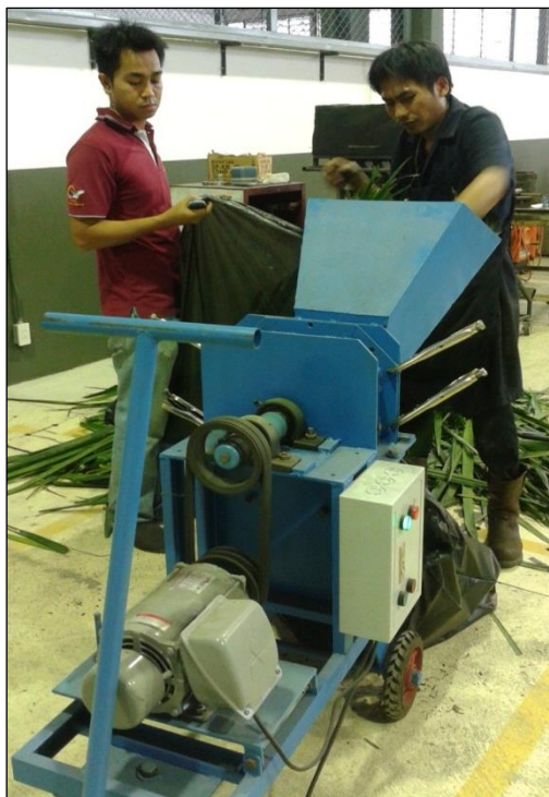
ภาพที่ 10. ใส่ใบปาล์มเข้าเครื่องสับย่อย
