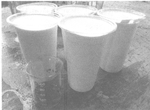
รูปที่ 3-9 การผลิตยางก้อนถ้วยด้วยการเติมสารธรรมชาติ
