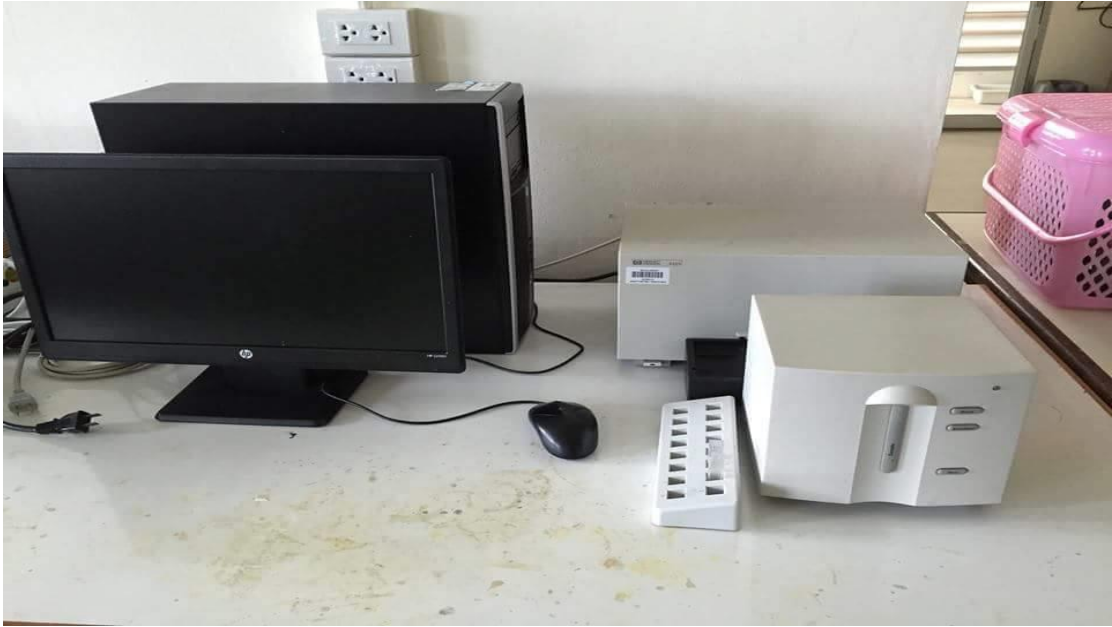
รูปที่ 3.7 เครื่องยูวี-วิสิเบิล สเปกโตรโฟโตมิเตอร์ (UV/VIS Spectrophotometer)
