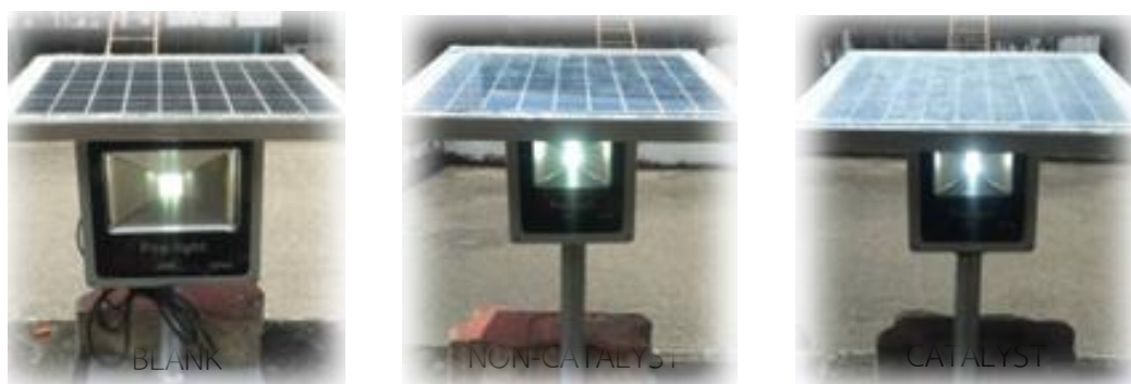
รูปที่ 4.15 การทดลองใช้สารเคลือบผิวบนโซลาร์เซลล์เพื่อวัดแรงดันทางไฟฟ้า
