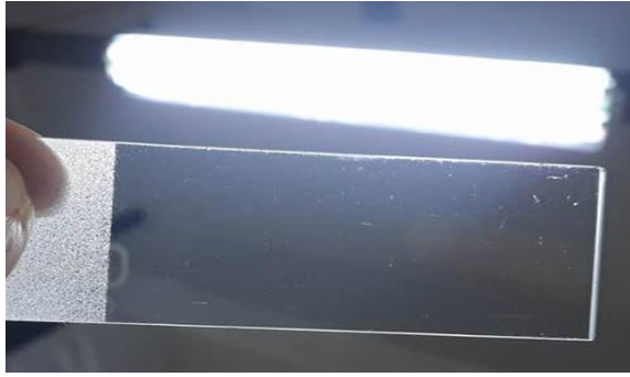
รูปที่ 4.3 กระดาษที่ผ่านการเคลือบด้วยวิธีที่ 2 ที่ความเข้มข้นของ HDTMS ร้อยละ 1 โดยปริมาตร
