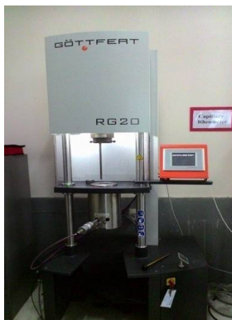
ภาพที่ 3.7 เครื่องทดสอบสมบัติการไหล (Capillary Rheometer) รุ่น Geotfert-Rheograph 20
