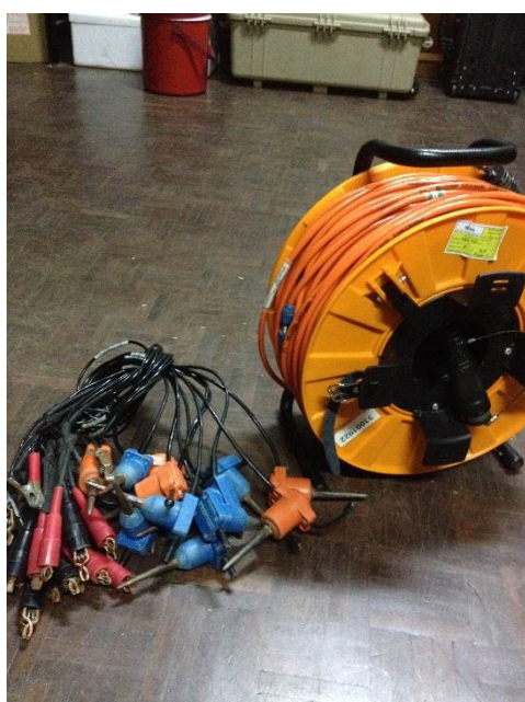
รูปที่ 3.4 อุปกรณ์และเครื่องมือที่ใช้ในการเก็บข้อมูลคลื่นไหวสะเทือน seismograph b) จีไอโฟนและเคเบิล c) ค้อนและแผ่นเหล็กรับการกระแทก
