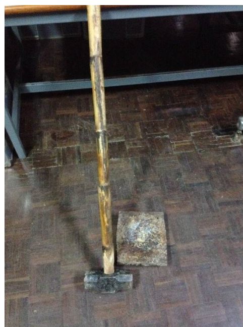
รูปที่ 3.4 อุปกรณ์และเครื่องมือที่ใช้ในการเก็บข้อมูลคลื่นไหวสะเทือน seismograph b) จีไอโฟนและเคเบิล c) ค้อนและแผ่นเหล็กรับการกระแทก
