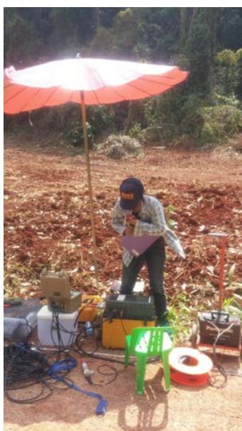
รูปที่ 3.5 (a) รูปแบบการสำรวจด้วยวิธีคลื่นไหวสะเทือนแบบสะท้อน และ (b) ภาพแสดงการเก็บข้อมูลภาคสนาม
