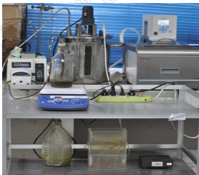
ภาพที่ 3.9 ระบบถังปฏิกรณ์ CSTR สำหรับผลิตไฮโดรเจน
