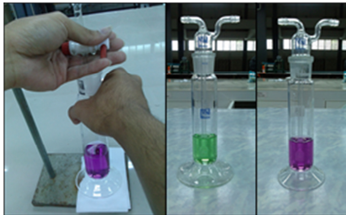
รูปที่ 3-21 การวิเคราะห์ความเข้มข้นของแอมโมเนียในอากาศเสียด้วยวิธีการไทเทรต
