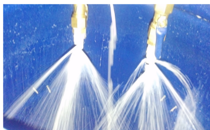
รูปที่ 4-7 ลักษณะพ่นละอองทางน้ำยางของหัวสเปรย์ที่ต่อแบบขนานระนาบเดียวกัน
