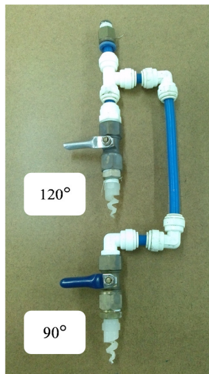
รูปที่ 4-8 การต่อหัวสเปรย์ 2 หัว แบบขนานบน-ล่าง
