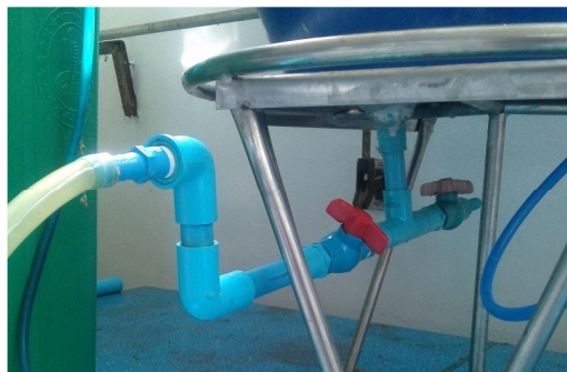
รูปที่ 3-5 ท่อรูปตัวยูทางออกของเหลวของคอลัมน์สเปรย์
