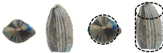
รูปที่ 3.11 แบบจำลองปริมาตรเมล็ดด้วยทรงกระบอกหน้าตัดวงกลม
