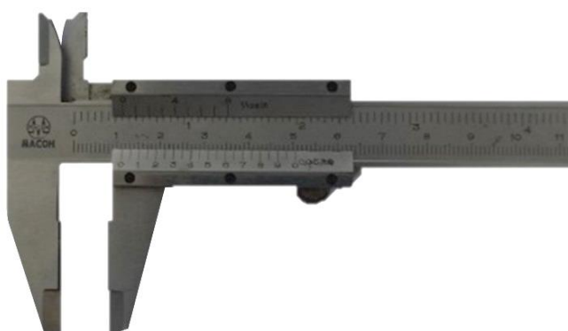
รูปที่ 3.1 เครื่องมือวัดขนาดของเมล็ดทานตะวันคือ เวอร์เนียคาลิปเปอร์
