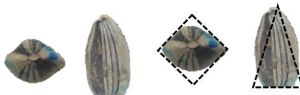
รูปที่ 3.12 แบบจำลองปริมาตรเมล็ดด้วยพีระมิดหน้าตัดสี่เหลี่ยม
