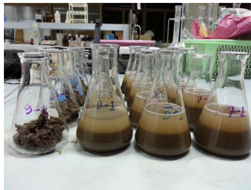
ภาพประกอบที่ 3.7 ลักษณะทางกายภาพที่สังเกตได้ขณะที่ทำการทดลองการล้างตะกอนที่ผ่านการปรับสภาพทางเคมีรีดน้ำแล้วของโรงงาน
