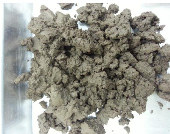
ภาพประกอบที่ 3.18 ลักษณะกากตะกอนจากระบบบำบัดน้ำเสียบแบบแอกติเวเต็ดสลัดจ์ของอุตสาหกรรมน้ำยางข้นที่ผ่านการปรับสภาพและรีดน้ำแล้ว
