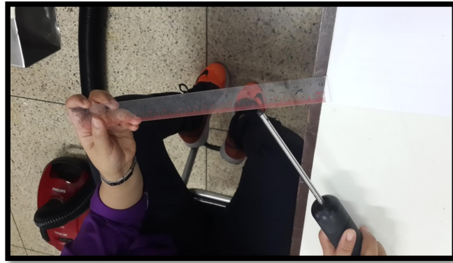
ภาพที่ 3.6 การตรวจวัดสารเคมี Ethanol โดยใช้อุปกรณ์ตรวจวัดก๊าซชนิดอ่านค่าได้ทันที
