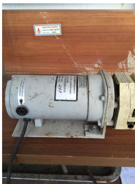
รูปที่ 2.6 ปั๊มที่ใช้ในการหมุนเวียนน้ำชะมูลฝอย
