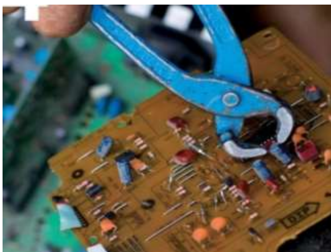
ภาพที่ 1-9 แผงวงจรอิเล็กทรอนิกส์ถูกแยกชิ้นส่วนในขณะที่ซ่อมส่วนที่ชำรุด ที่มา: ปเนต มโนมัยวิบูลย์ และคณะ, 2552
