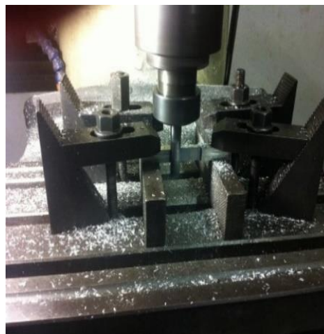
รูปที่ 3.20 การเตรียมชิ้นงานสำหรับทดสอบความทนแรงดึง
