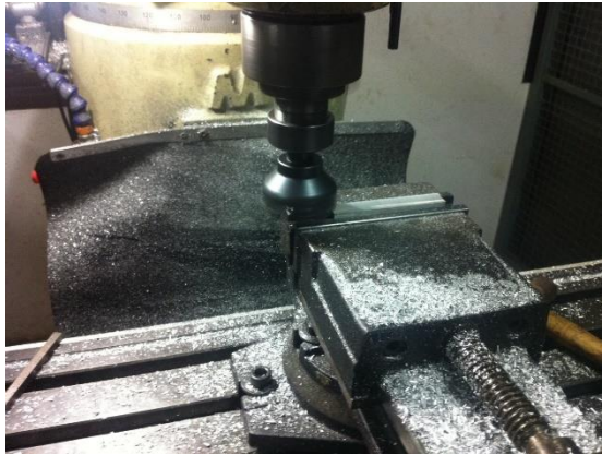
รูปที่ 3.17 กัดปาดหน้าชิ้นงานให้เรียบก่อนนำไปวัดความแข็ง
