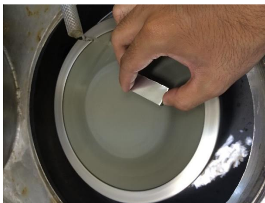
รูปที่ 3.15 การขัดชิ้นงานด้วยกระดาษทรายน้ำ
