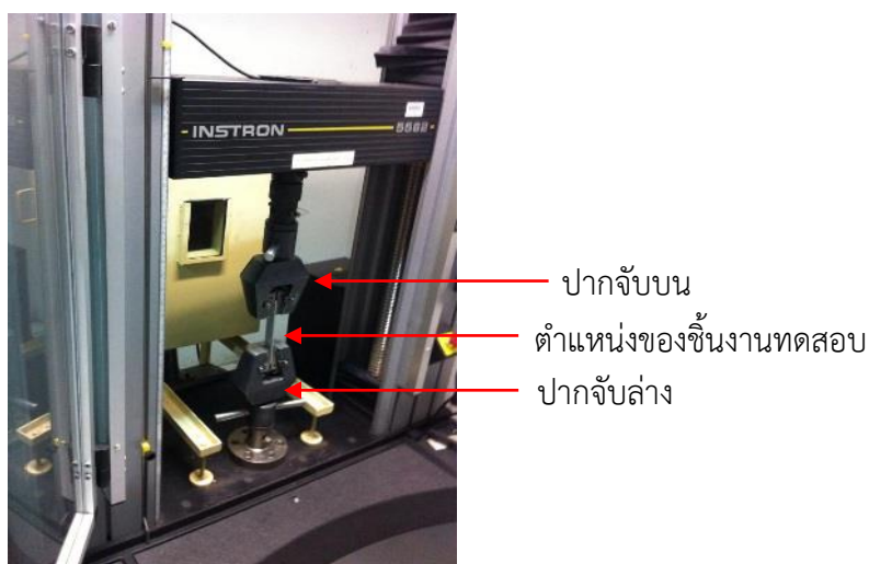
รูปที่ 3.23 การติดตั้งชิ้นงานทดสอบความทนแรงดึง
