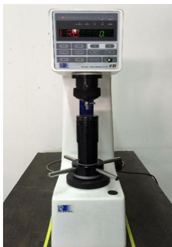
รูปที่ 3.11 เครื่องทดสอบความแข็งแบบร็อคเวลล์
